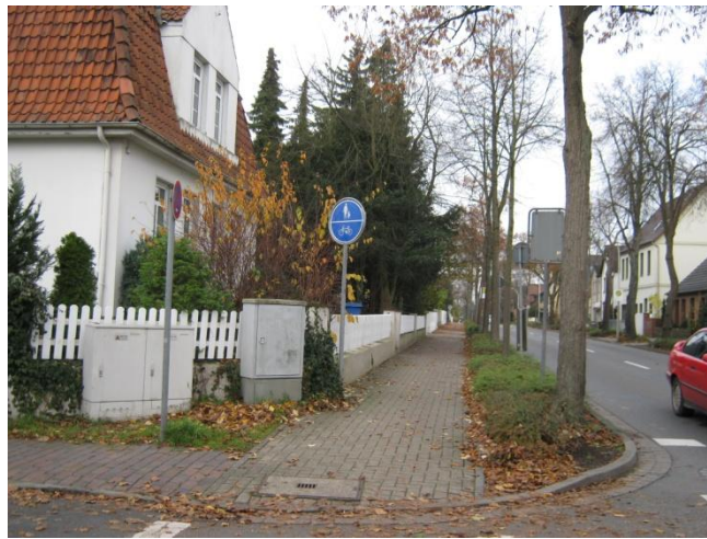
Abb. 5-21: Eitzer Straße in Verden - Beidseitig gemeinsamer Geh- und Radweg für den Zweirichtungsverkehr in unzureichender Breite
